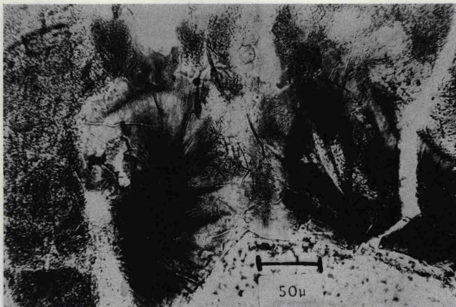
Abb. 26. Strahlige Feldspatkristalle. Aus einer stark rekristallisierten Glasbombe im Suevit von Bollstadt.
