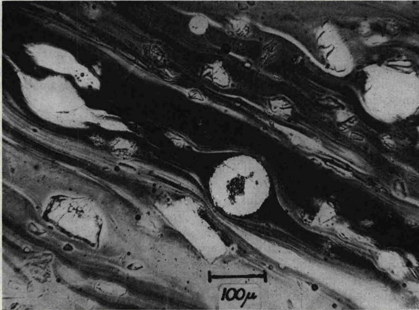
Abb. 22. Nicht rekristallisiertes Glas mit Schlieren, Blasen und Mineralfragmenten. Glasbombe aus dem Suevit von Otting.
