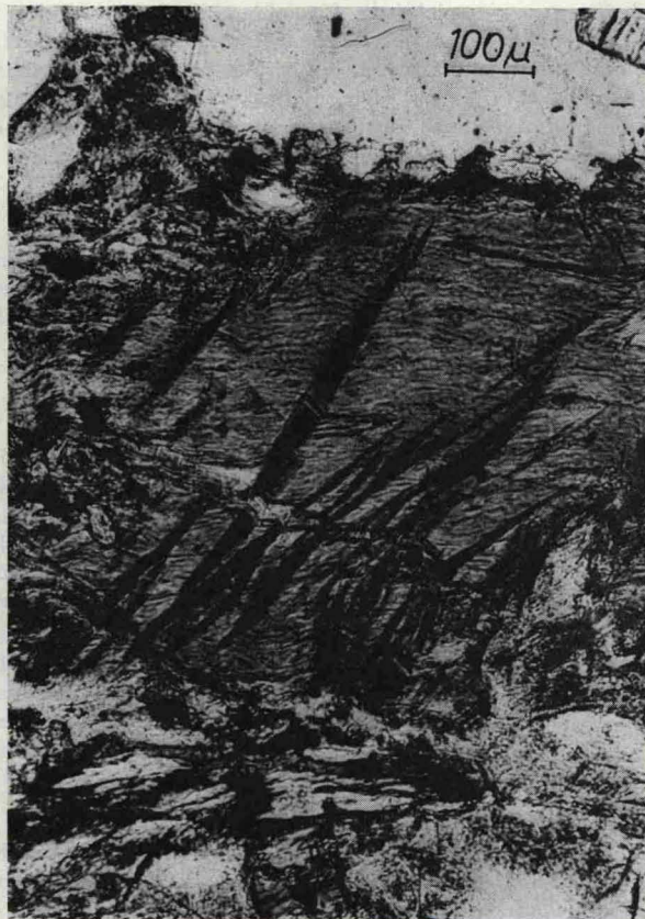
Abb. 15. Knickbänder in Biotit. Aus einem Gneis-Einschluß im Suevit von Zipplingen (S. 349).
